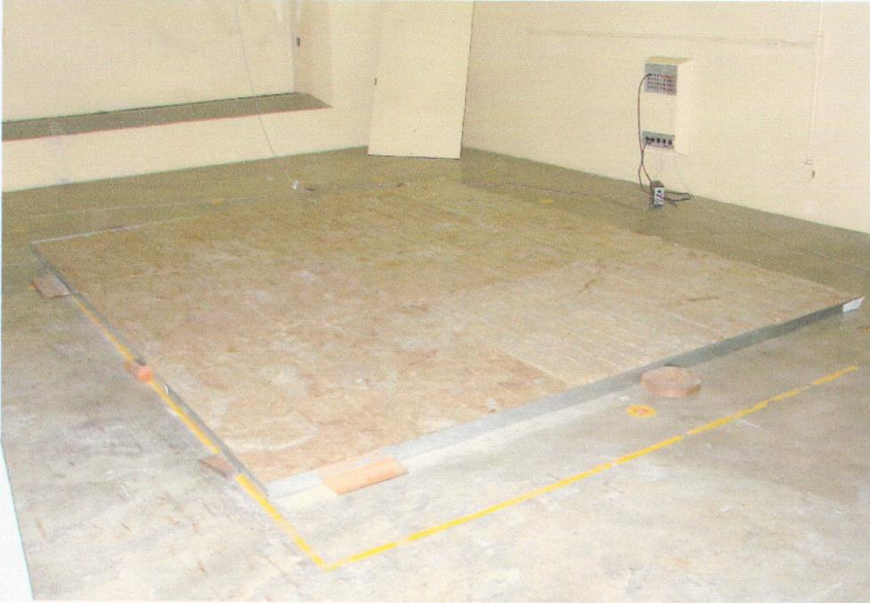
Foto 1: Vista da montagem dos painéis de lã de rocha na câmara reverberante.
